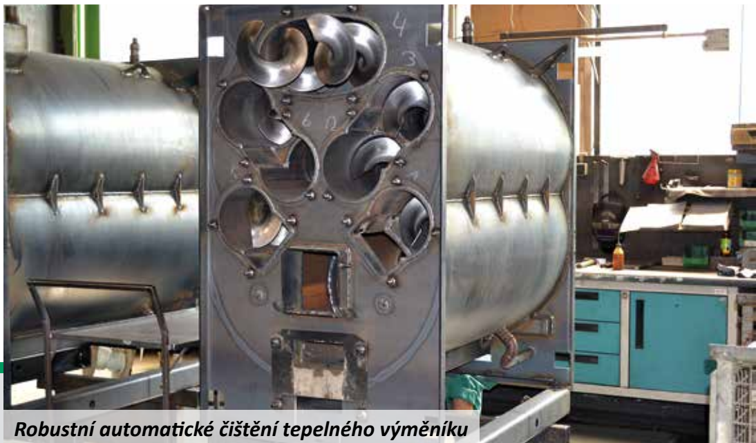
Spalinová komora s nejlepšími emisními hodnotami
